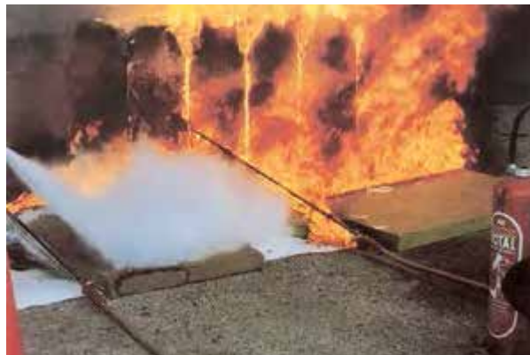
Schmelzende Dachbaustoffe (hier: Bitumen) stellen eine hohe Gefahr dar.
